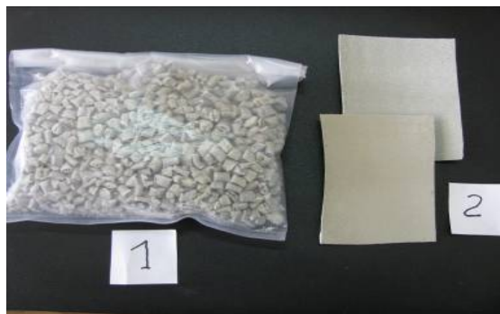
Рис. 2. Фотографии гранулированного материала (1) и ленты (2), полученной на основе кукурузного крахмала, сорбитола, белого полипропилена, с использованием компатибилизатора-малеинового ангидрида
