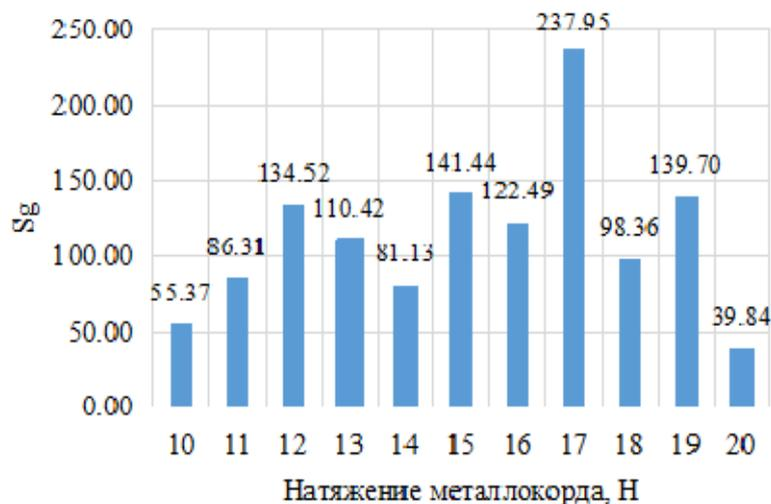
Рис. 1. Зависимость критерия Sg от натяжения металлокорда 2x0,25UT перед намоткой
