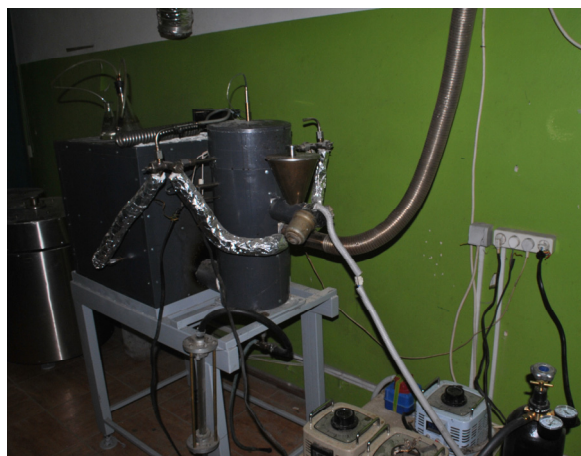
Рис. 1. Общий вид экспериментальной установки по пиролизу биомассы
