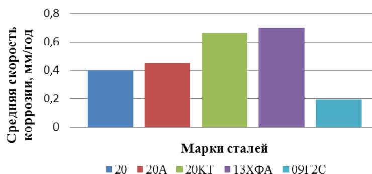
Рис. 1. Скорость коррозии труб различных марок стали марки
