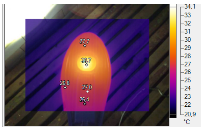
Рис 1. Термограмма по определению температурных характеристик светильника
