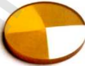
Рис. 1. Аксикон-базисный элемент для получения квазибездифракционных градиентных световых полей
