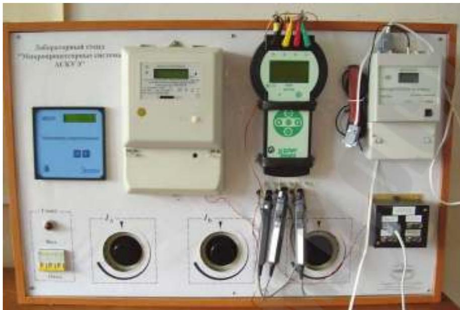
Рис. 2. Внешний вид лабораторного стенда «Микропроцессорные системы АСКУЭ»
