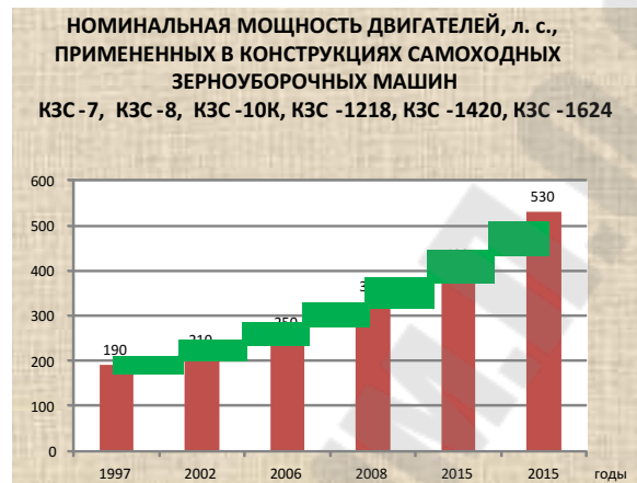
Рис. 2. Энергонасыщенность самоходных зерноуборочных машин ОАО «Гомсельмаш» с 1997 по 2015 г.
