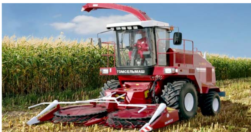
Рис. 6. Кормоуборочный комбайн КВК-800-36 с жаткой для уборки грубостебельных культур
