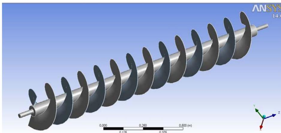
Рис. 1. 3D-модель 2-виткового шнека, построенная в ANSYS WorkBench
