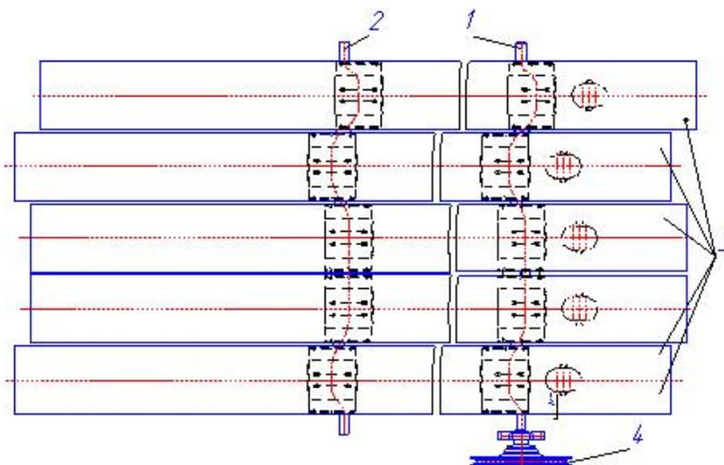
Рис. 1. Пятиклавишный соломотряс комбайна КЗС-10К:
