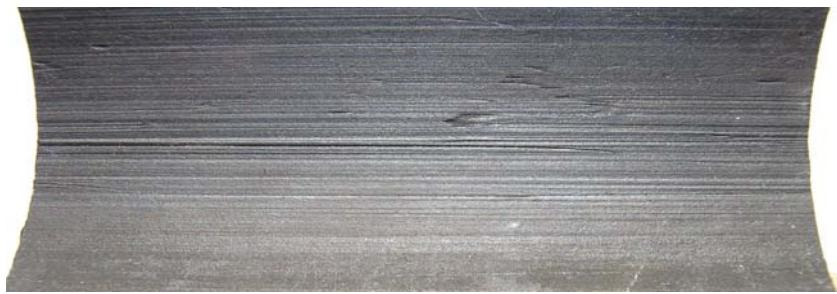
Рис. 1. Внешний вид дефектов на внутренней поверхности трубы
