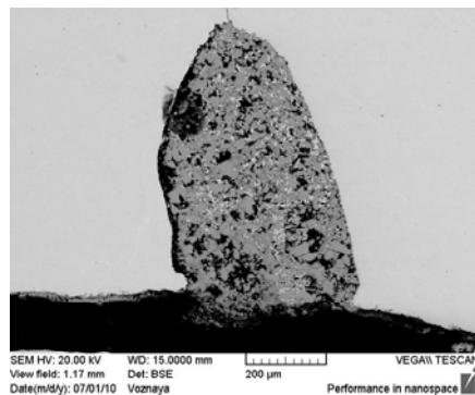
Рис. 2. Включения в полости дефекта
