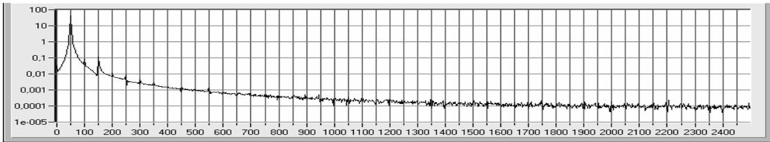
Рис. 8. Диаграмма частотного спектра тока инфракрасной лампы ДРЛ-250
