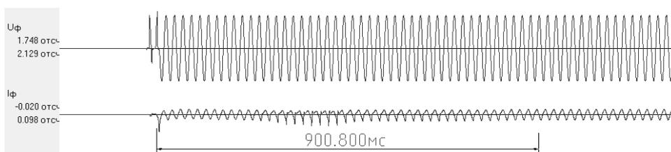
Рис. 7. Осциллограммы тока и напряжения при включении лампы ДРЛ-250
