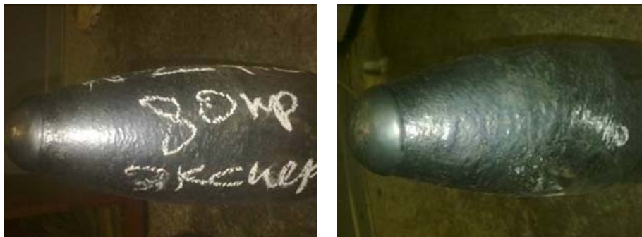
Рис. 4. Износ опытной оправки № 002 после 80 проходов
