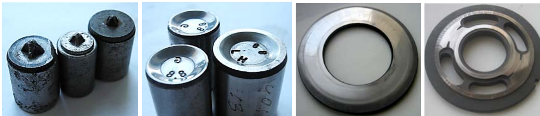
Рис. 1. Примеры деталей, традиционно изготавливаемых из стали X12M: а, б – холодновысадочные пуансоны для окончательного формирования головки метизов; в, г – детали аксиально-поршневых насосов
