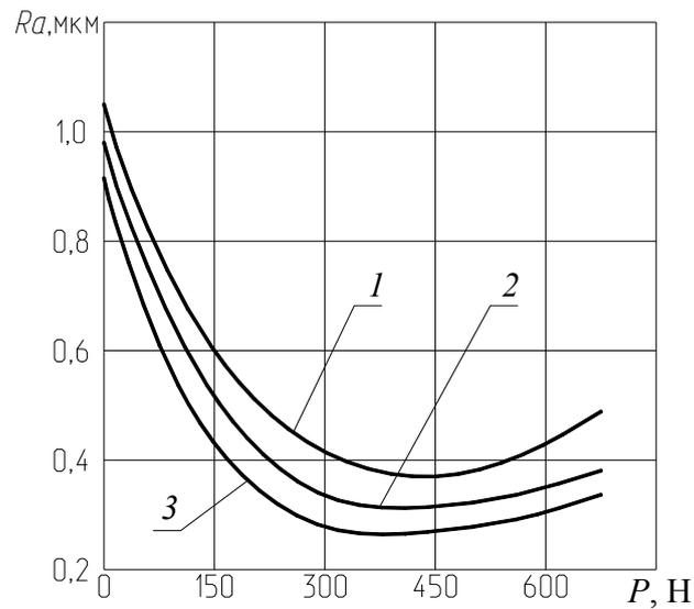
Рис. 2. Зависимость шероховатости  $Ra$  от силы  $P$  при выглаживании закаленных сталей ( $R = 2,0$  мм;  $S = 0,05$  мм/об):
