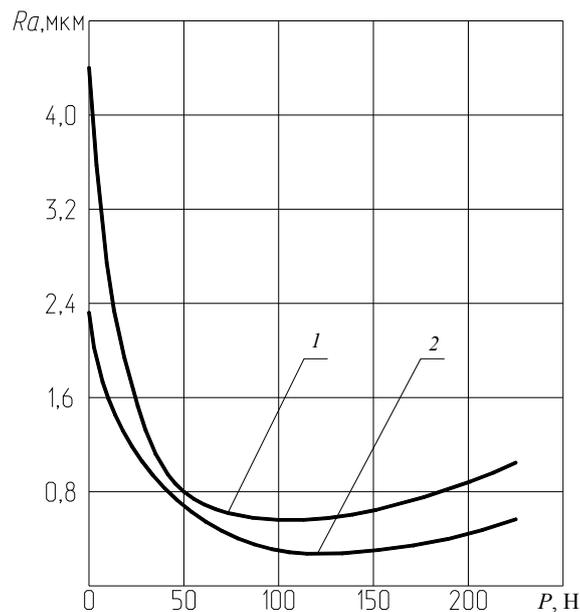
Рис. 3. Зависимость шероховатости  $Ra$  от силы  $P$  при выглаживании мягких материалов ( $R = 2,0$  мм;  $S = 0,05$  мм/об):
