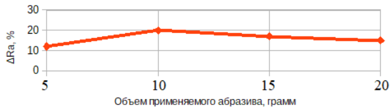
Рис. 1. Зависимость \Delta Ra от объема применяемого магнитного абразива
