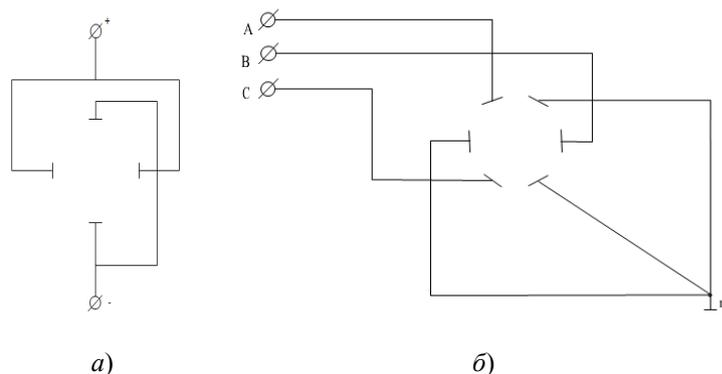
Рис. 4. Система питания диэлектрического двигателя:
