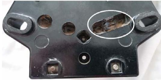
Рис. 4. Хищение электроэнергии с помощью изменения месторасположения шунта
