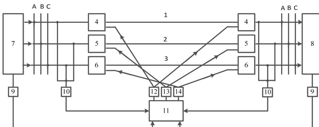
Рис. 1. Принципиальная электрическая схема электропередачи переменного тока
